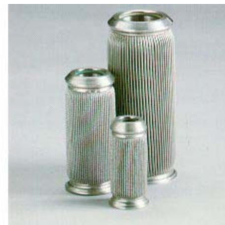
Tipo: DR, DA, DH (Elemento filtrante de pressão) Tamanho: 030, 060, 160, 330, 660, 990 Pressão diferencial: 210 bar Temperatura operacional: até 400 °C Fixação: Conexão de encaixe Desenho Nº: 285 052, 289 950
