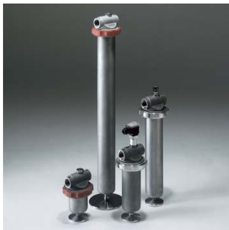
Tipo: PFL/PFM/PFH (Filtro de processo de baixa pressão / média pressão / alta pressão de aço inoxidável) Tamanho: 0, 1, 2, 3 Pressão operacional: 16 / 40 / 100 bar Conexão: G 1" Temperatura operacional: até 200 °C Catálogo Nº: 7.707../..
