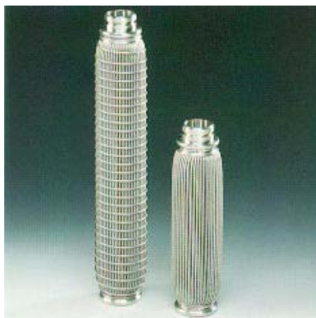
Tipo: SZ (Elemento filtrante de sistema) próprio para PFL/PFM e ENF tamanho: 0, 1, 2, 3 Pressão diferencial: até 40 bar Temperatura operacional: até 200 °C Fixação: Conexão de encaixe Desenho Nº: 543 736, 554 719
