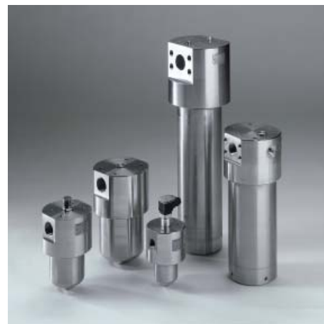
Tipo: EDFR, EDFA (Filtro de pressão de aço inoxidável) Tamanho: 060, 160, 330, 660, 990 Pressão operacional: 400 bar a 200 °C Conexão: G 1/4", G 1/2", G 3/4" Temperatura operacional: até 400 °C (com vedação metálica) Catálogo Nº: 7.703../..
